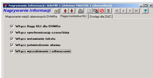
Rysunek 6 –Włączenie funkcji sterowania rejestratorem po RS232.
